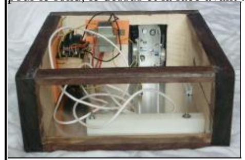
Le boîtier pour l'alimentation. Du bois pour les cotés, des feuilles de métal pour le fond, le dessus et la face avant :
